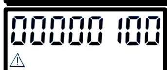
Температура эксплуатации теплосчетчика вышла за пределы допустимых значений
