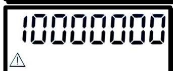
Любой из датчиков неисправен, или разность температур датчиков менее двух градусов
