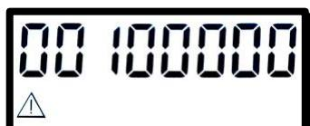
Неисправность температурного датчика № 1
