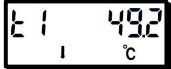
Температура подающего трубопровода
