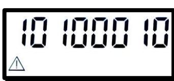
Неисправность температурного датчика № 1.
