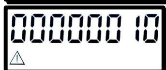
Вскрыт корпус теплосчетчика
