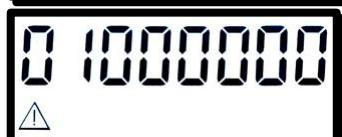
Неисправность температурного датчика № 2
